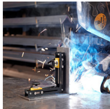
Быстрая установка прямого угла для малых и больших заготовок
